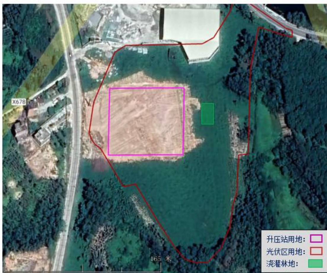
图 5-2 项目废水浇灌地位置情况图
