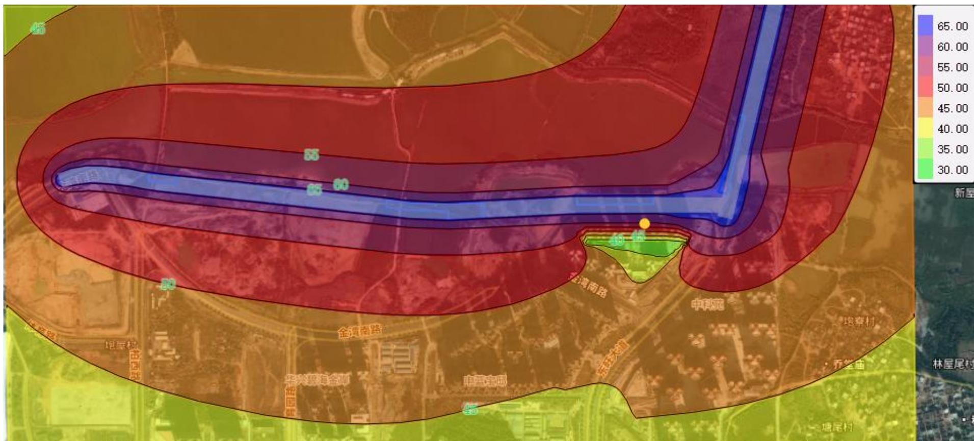
图 4-11 海旺路桥梁、东旺大桥远期昼间等声值线图
