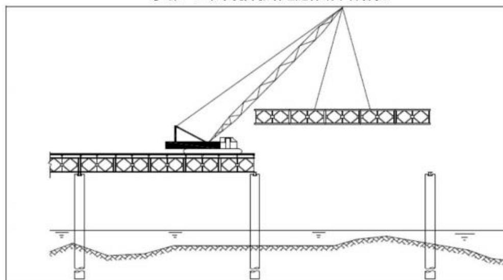
**步骤二：吊装推进施工钢平台**
